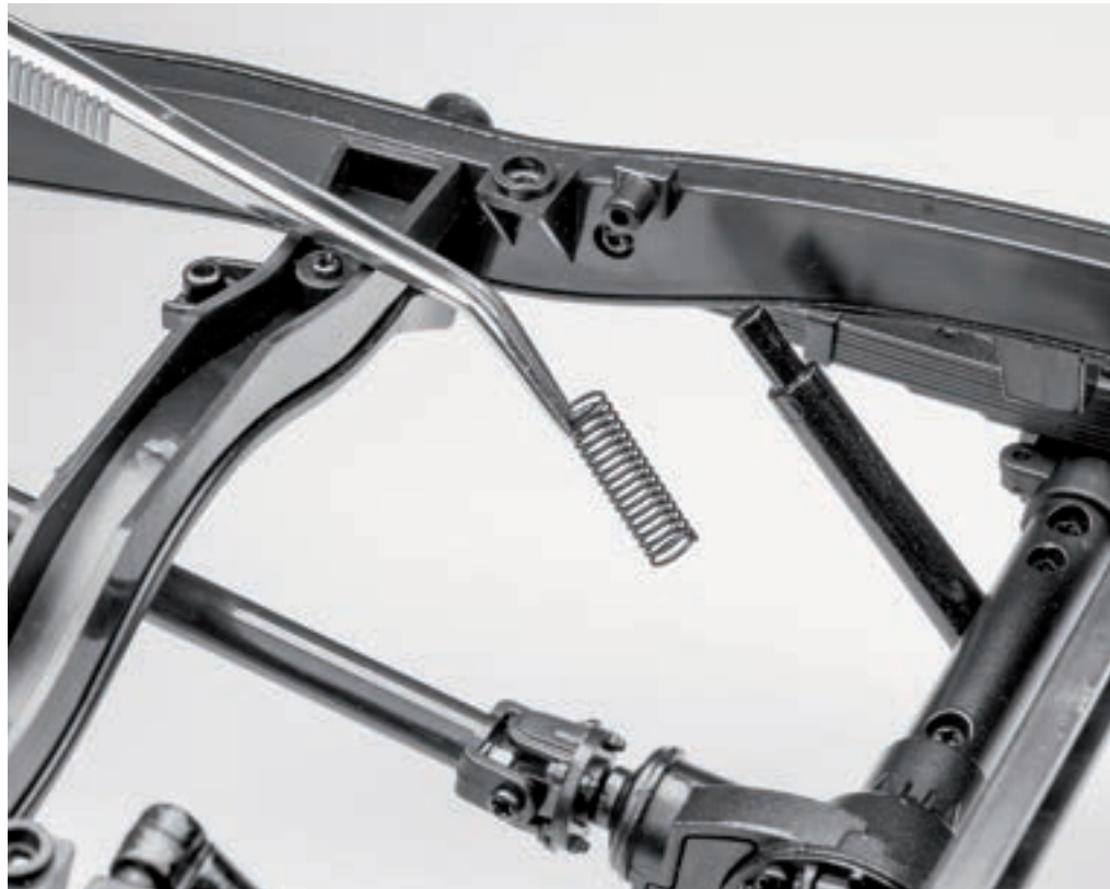
Шаг 8. Поместите пружину на шток правого амортизатора заднего моста.
