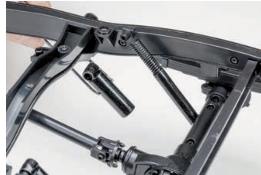
Шаг 9. Поверх пружины установите кожух амортизатора. При помощи винта 2,3×5 (LP) закрепите кожух амортизатора на кронштейне правого лонжерона рамы.
